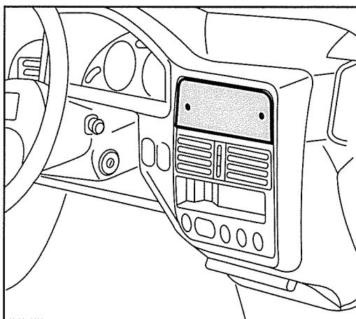
L'interrupteur et le fusible devront être obligatoirement montés à l'emplacement d'origine de l'autoradio (en grisé sur le dessin ci-dessus), le relais lui pourra être monté :
